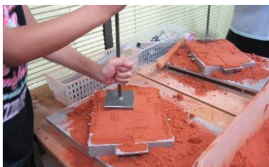
型枠にバンゲル原型を置き 鑄物砂を詰めます。
