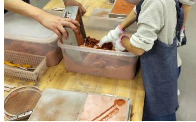
スズが固まったら型から外して ヤスリ等で仕上げて完成!
