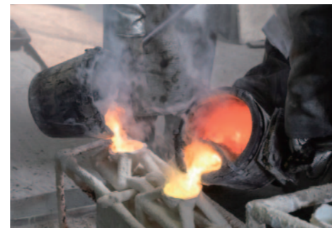
鑄型に黒味銅を溶かしたものを注湯。 Melted kuromido is poured into the casting mold.
