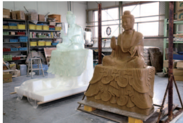
3Dプリントによって制作された原型をもとに、 鋳造用の型を作成しました。 The casting molds are created based on the 3D-printed resin sculptures.
