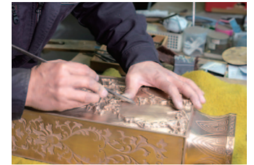
手ヤスリやタガネで仕上げを施す。 Finishing the surface using hand files and chisels.
