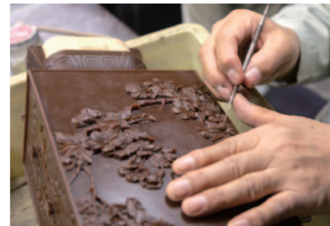
ワックス型を細かく修正する。 The wax mold is carefully touched up.
