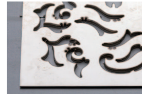
ウォータージェットで切断された白四分一。 White shibuichi cut with a water jet cutter.
